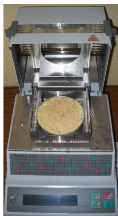
Contrôle de l'humidité du maïs en cours de campagne par dessiccateur
