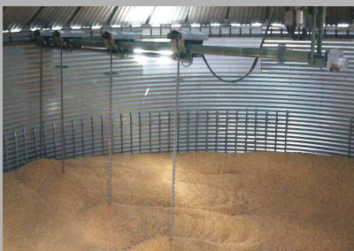
Brassage mécanique qui optimise les performances de séchage
