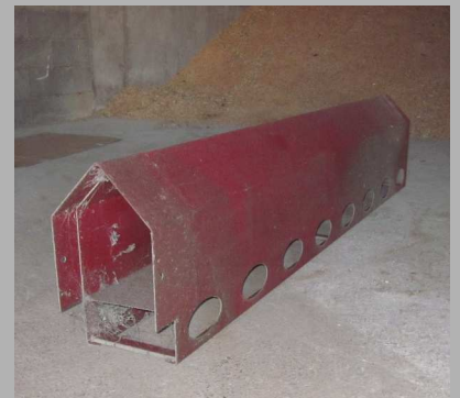
Gaine de ventilation
