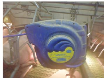
Enrouleur pour l'air comprimé
