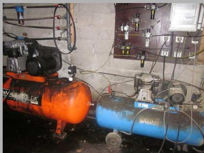
L'idéal est d'avoir deux compresseurs. On peut par exemple utiliser un vieux compresseur remis en état qui se met en marche quand l'autre est en panne. De plus, en faisant passer l'air dans ce deuxième compresseur, on retire une grande partie de l'eau contenue dans l'air.
