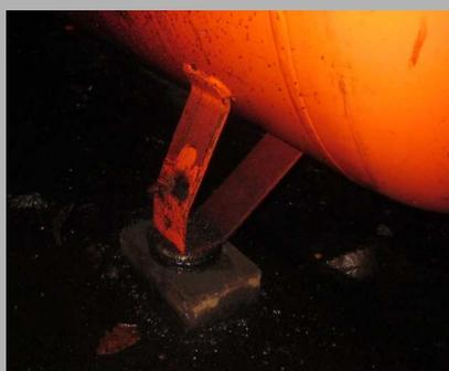
*Compresseur sur cylindre bloc, posé sur cale de bois pour stabiliser le compresseur*
